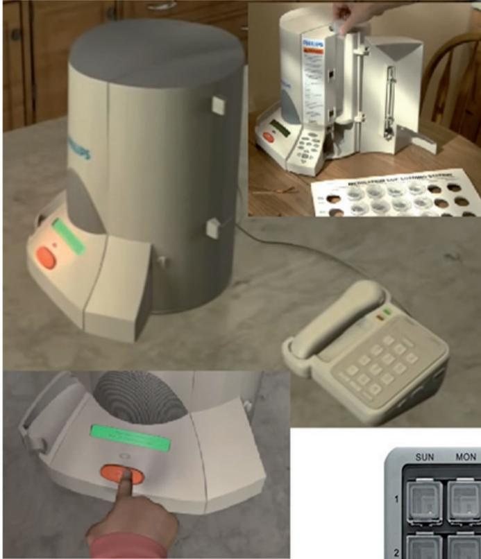
Figura 4.9. Esquema de funcionamiento de Medication Dispensing Service: aparato dispensador conectado al teléfono.
